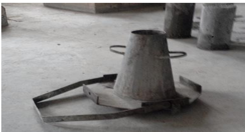
Fig.2. Slump cone apparatus
